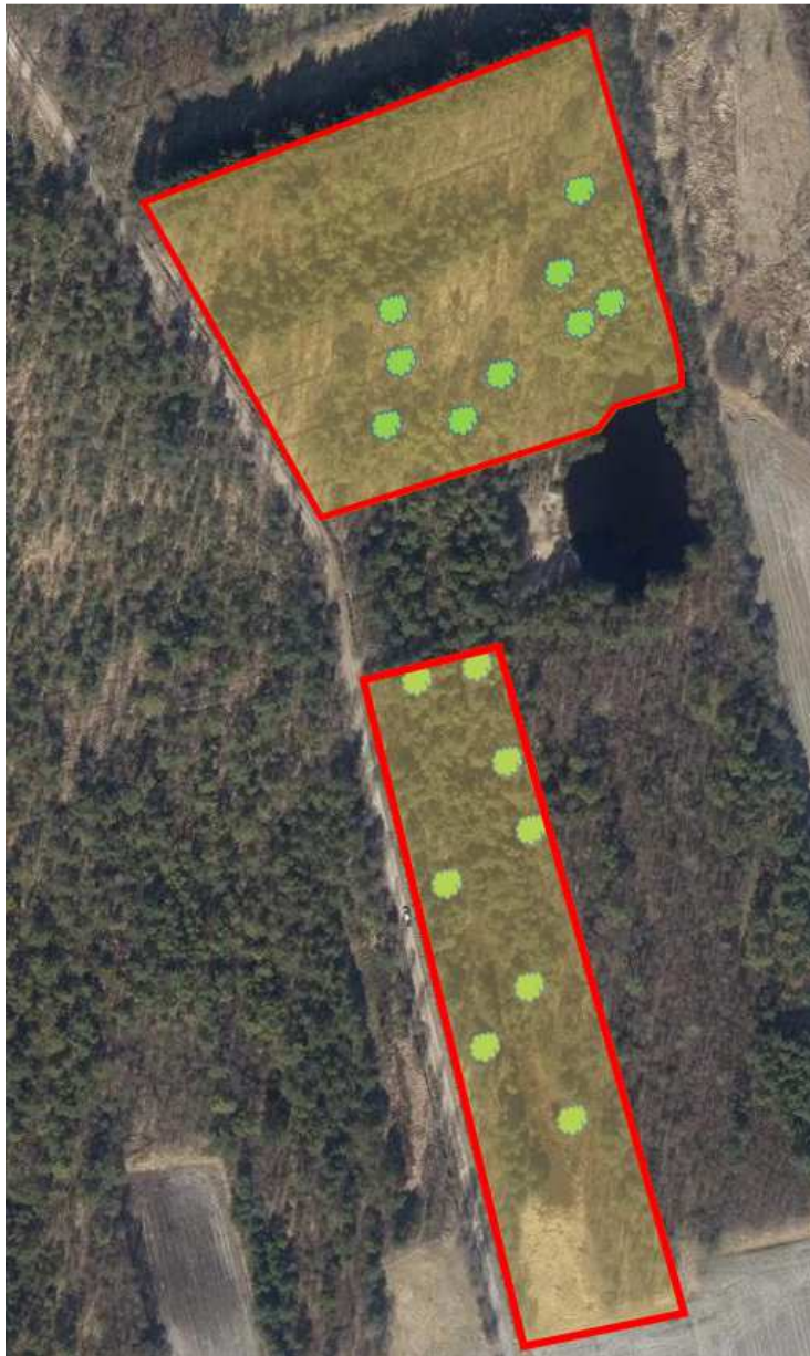
Abb.3: Rodung des Gehölzbestandes (rot umrandet + orange hinterlegt) unter Belassung von Solitärbäumen
